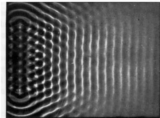
Interferenz von acht kreisförmigen Wasserwellen, deren Erregungszentren auf einer Geraden liegen
