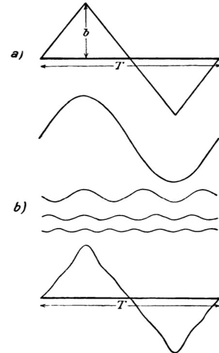
Fourier-Zerlegung einer periodischen Dreieckskurve
