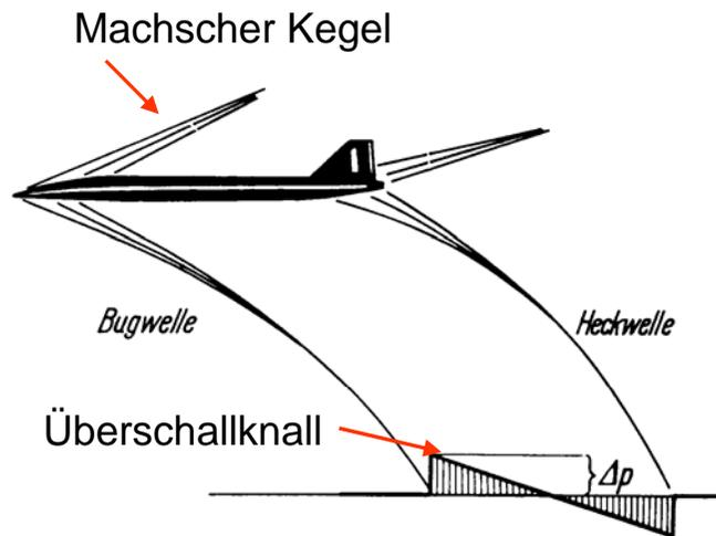
Stoßwellen eines Überschallflugzeuges (Bug- und Heckwelle) mit dem Druckverlauf (Drucksprung  $\Delta p$ ), den die beiden Wellen am Erdboden erzeugen
