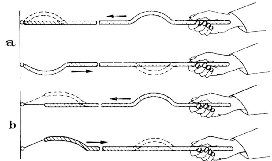
Reflexion einer Transversalwelle; a) an einer festen Wand, b) an einem freien Ende
