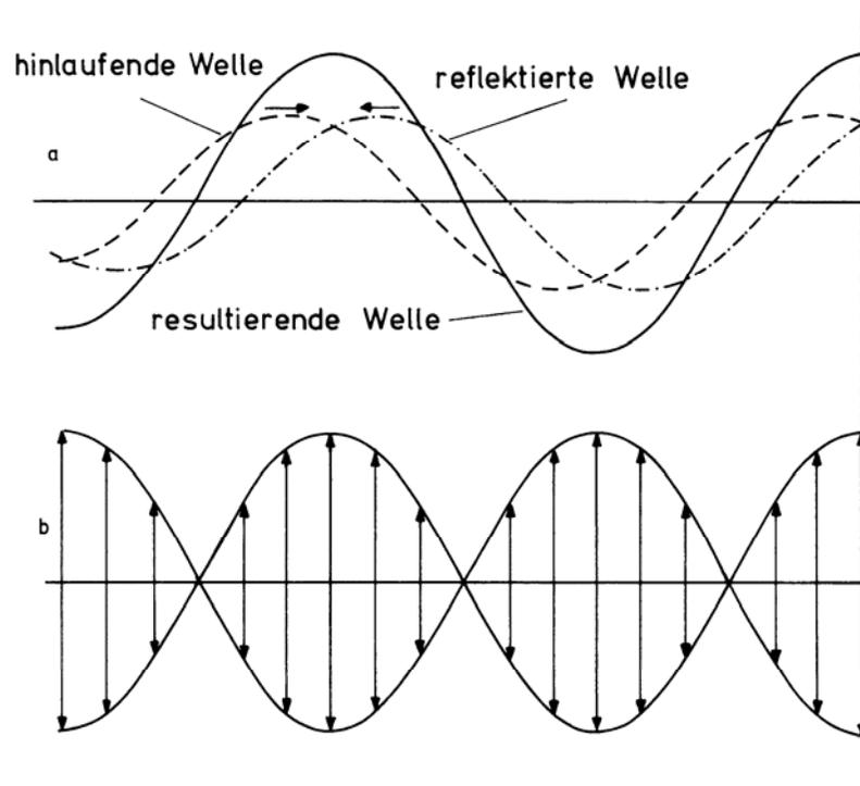
(a) Hinlaufende und am freien Ende reflektierte Seilwelle und Superposition der beiden (Momentanbild); (b) stehende Welle (Verlauf der resultierenden Amplitude).
