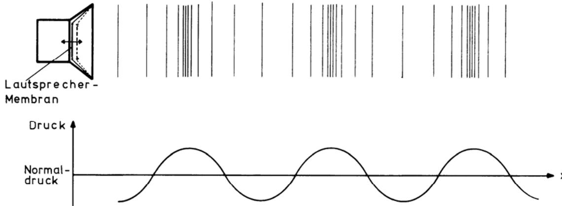
Schwingung einer Lautsprechermembran erzeugt geringfügige periodische Dichteänderungen der Luft (Über- und Unterdruck).
