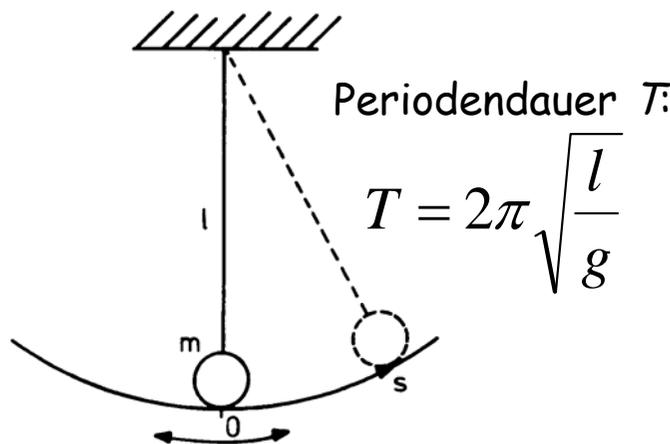
Fadenpendel ( $m$ : schwingende Masse,  $l$ : Fadenlänge,  $0$ : Ruhelage,  $s$ : krummlinige Bahnkoordinate).
